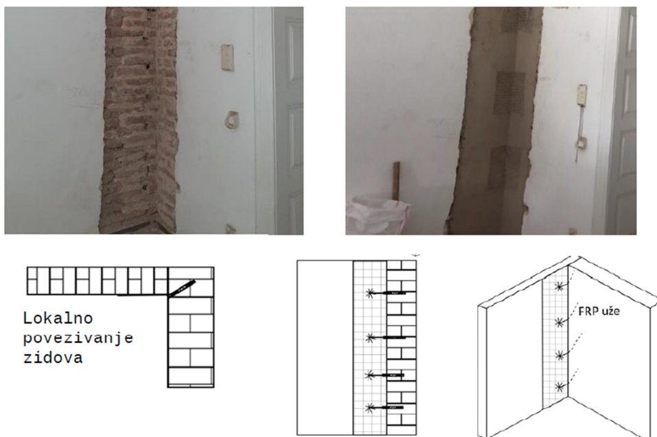
Slika 28. Sanacija spoja nosivih zidova
